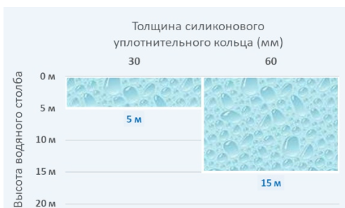
Зависимость m и BC от толщины силиконового уплотнительного кольца ASOKA SPD/N
