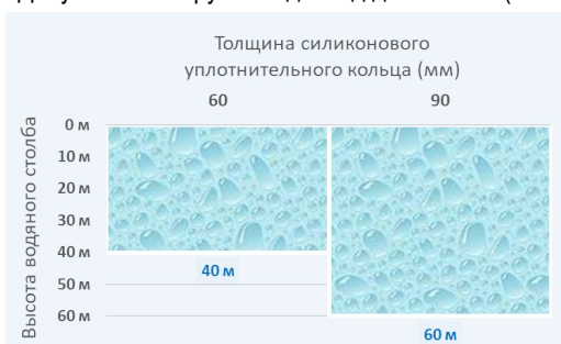
Зависимость m и BC от толщины силиконового уплотнительного кольца ASOKA SPD/Q
