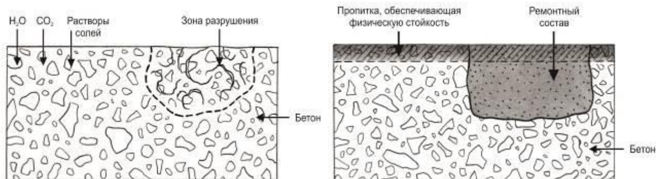
Рисунок Д.2 – Схематичное изображение метода 5.2 до и после применения
